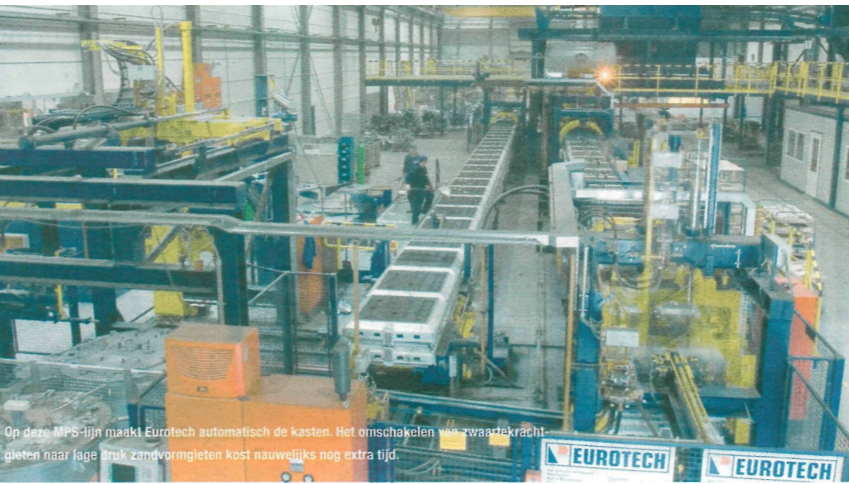
Op deze MPS-lijn maakt Eurotech automatisch de kasten. Het omschakelen van zwaartekrachtgieten naar lage druk zandvormgieten kost nauwelijks nog extra tijd.
